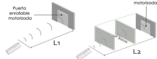
Configure la posición del límite antes de su uso. El método de configuración se puede consultar en: 6 Configuración de la posición del límite superior/inferior
